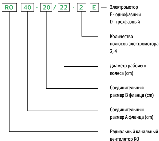
РИС. 1 – ТИПОВОЙ КЛЮЧ ДЛЯ ОБОЗНАЧЕНИЯ ВЕНТИЛЯТОРОВ RO
