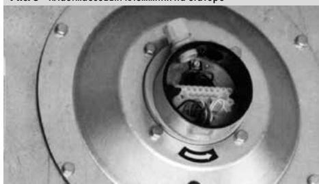
Рис. 8 – пластмассовый клеммник на статоре
