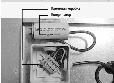
Рис. 10 – клеммная коробка и конденсатор (одноф. двигатель)
