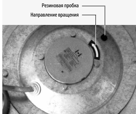
Рис. 12 – резиновая пробка контрольного отверстия
