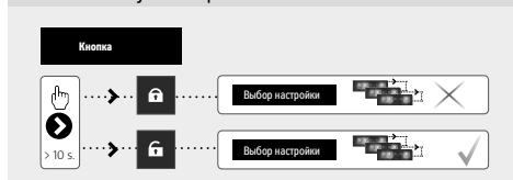
Рис. 40 – Замкнутые настройки насоса
