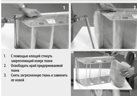
Рис. 61 – замена фильтрационной ткани
