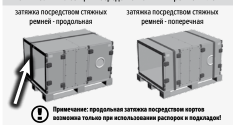
Рис. 4 – затяжка секций посредством стяжных ремней и лент
