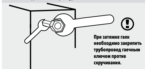
Рис. 30 – подключение арматуры к теплообменникам
