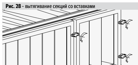
Рис. 28 - вытягивание секций со вставками
