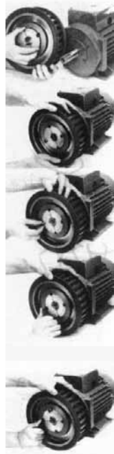
Рис. 17 – зажимная втулка Taper Lock®
